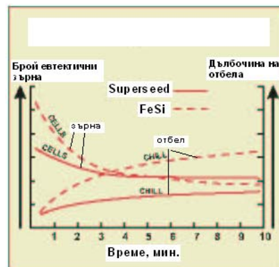
Фиг. 5 Характеристики на затихването на Superseed® 75 и Foundry Grade 75 % феросилиций.
