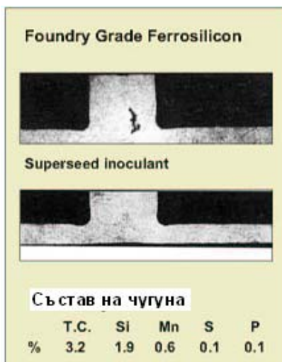
Фиг. 4 Склонност към образуване на всмукнатини при използването на различни модификатори.
