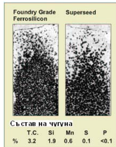
Фиг. 3 За достигане на една и съща степен на намаляване на отбела за Superseed® 75 са необходими образуването на по-малко евтектични зърна. Дебелина на образците 5 мм.
