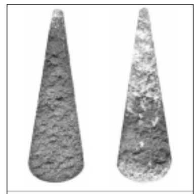
Bild 1: Deutliche Reduzierung der Weißeinstrahlung mit 0,1% Superseed Extra-Impfliegierung (links) als Pfannenzusatz im Vergleich zu 0,1 % Impf-FeSi (rechts) in Ausgangseisen mit 0,04 % Schwefel.
